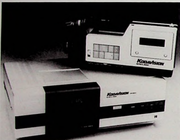
Bild 1: 8-mm-Kamerarecorder (oben) und Tuner-Timer-Rack (unten) zum Wiedergeben über Fernsehempfänger (Kodak-Pressbild)
